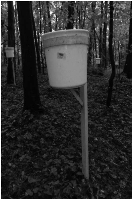
Fot. 2. Chwytacz opadu organicznego Photo 2. Organic fall container
